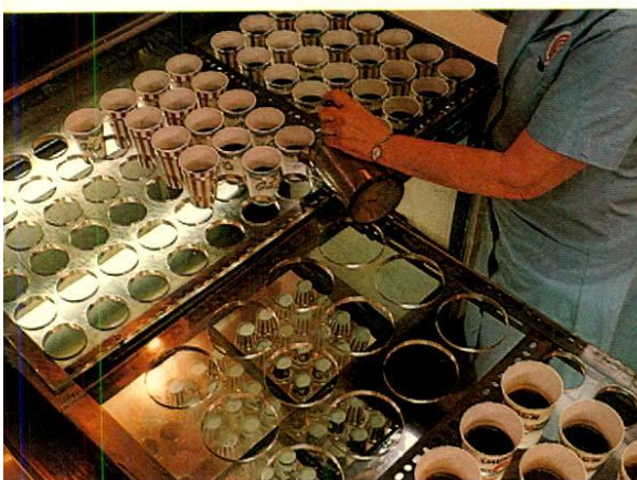
Du vrai café, bouillant, est utilisé pour les tests habituels du contrôle de la qualité des contenants en papier, à l'usine 10 de New Toronto.
